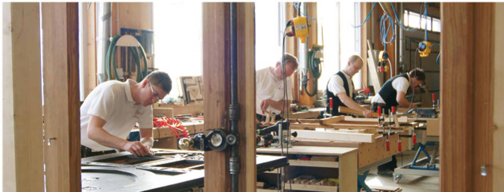
Werkstattarbeit: Restaurierung von historischen Fenster- und Türelementen
