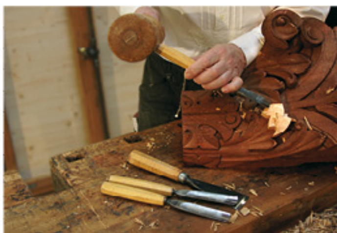
Handwerkliche Schnitzarbeiten an einem Kapitell (Gründerzeit, Neo-Renaissance) aus Eichenholz
