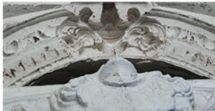
Spolienabformung (oben) mit Gipsausguss (unten)
