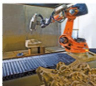
Fräsroboter bei der Vorbearbeitung eines Steins
