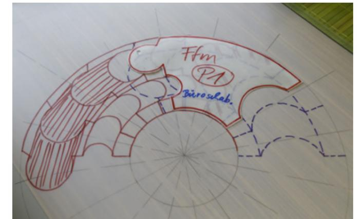
Konstruktionszeichnung für die Wendeltreppe der Goldenen Waage
